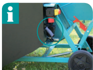
Einfache und stabile Zapfwellenabschaltmechanik über Keilriemenspannrolle, beliebig zu- bzw. abschaltbar
