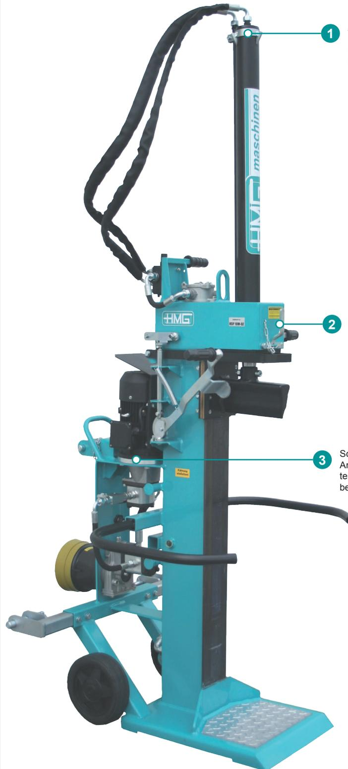
1 Zylinder für Transport absenkbar, dadurch nur noch 180cm hoch (Serie bei 10t-24t)
