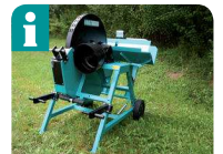
Dreipunktaufhängung, Fahrwerk mit großen Rädern und ausziehbaren Transportstange serienmäßig
