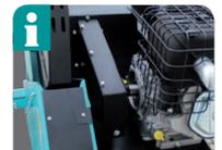
**Antrieb Sägeblatt über Keilriemenwelle** für mehr Arbeitssicherheit und schonender für die Antriebsquelle
