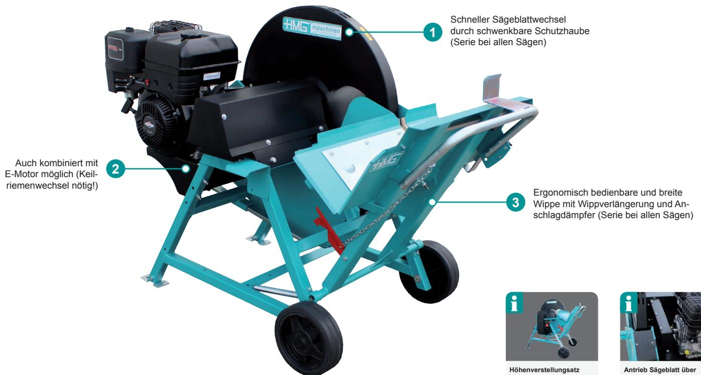
1 Schneller Sägeblattwechsel durch schwenkbare Schutzhaube (Serie bei allen Sägen)
