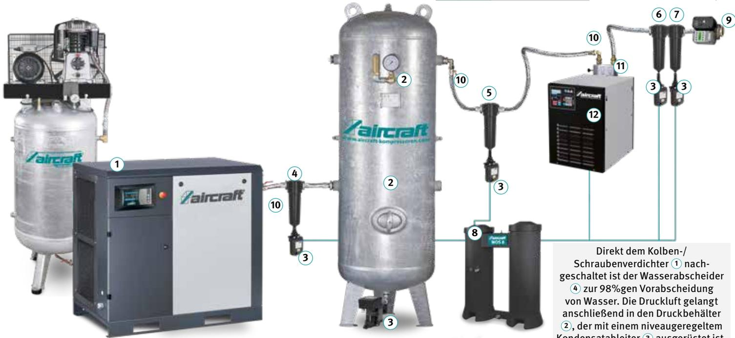
Direkt dem Kolben-/Schraubenverdichter ① nachgeschaltet ist der Wasserabscheider ④ zur 98%igen Vorabscheidung von Wasser. Die Druckluft gelangt anschließend in den Druckbehälter ②, der mit einem niveaugeregeltem Kondensatableiter ③ ausgerüstet ist. Vom Behälter aus geht es über den Feinfilter ① in den Druckluft-Kältetrockner ⑫.
