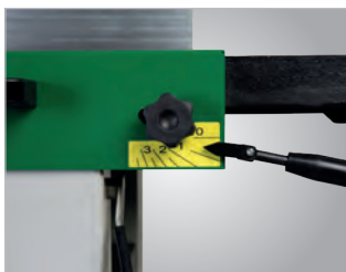
Verstellung der Spanabnahme über Bedienhebel
