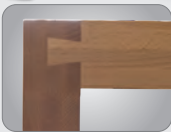
Schwalbenschwanzverzinkung in Hinterzange und Beiladerücken
