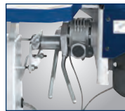
Schleifaggregat über Hebel bis 45° schwenkbar
