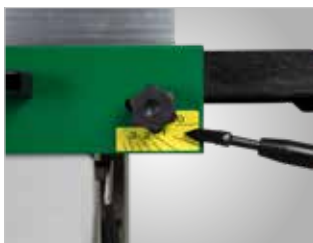
Verstellung der Spanabnahme über Bedienhebel
