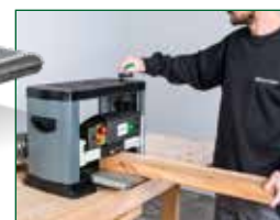
Höheneinstellung über Handkurbel und Skala
