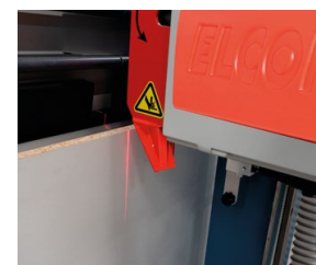
Schaltereinheit direkt am Sägeaggregat
