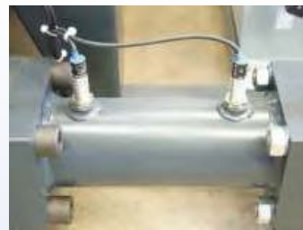
Verschleißfreie elektronische Sensoren
