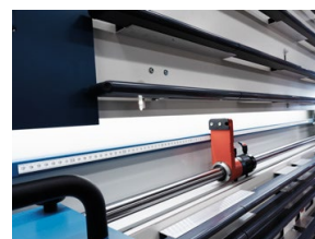
Schwerer Längsanschlag mit Feineinstellung, beleuchteter Skala
