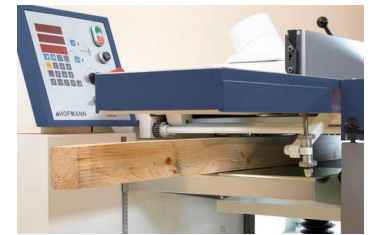
Dickenhobeln bei geschlossenem Tisch – ohne Umklappen – sogar gleichzeitiges Abrichten ist möglich – dadurch optimale Messerausnutzung
