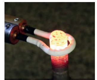
› Erwärmen eines Gewindebolzens mit der wassergekühlten Spule
