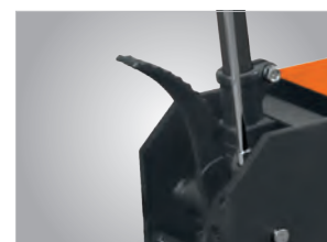
Zusätzliches Fußpedal zum Heben mit Schnellhub
